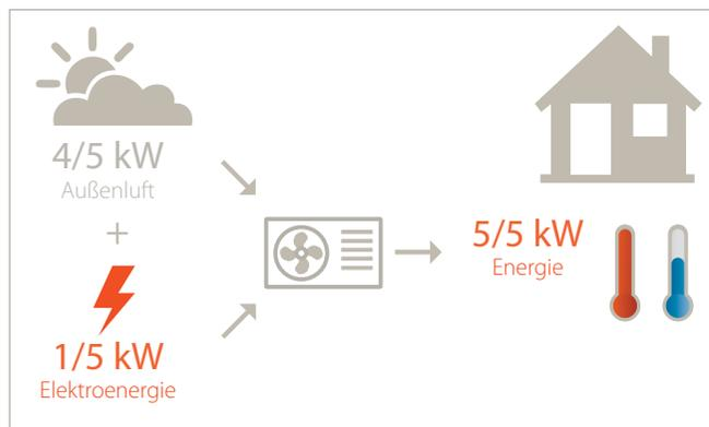
Bis zu 4/5 der von einer Wärmepumpe erzeugten Energie ist kostenfrei, da sie der Außenluft entzogen wird. Das heißt, dies ist eine kostenfreie und unerschöpfliche Ressource!
